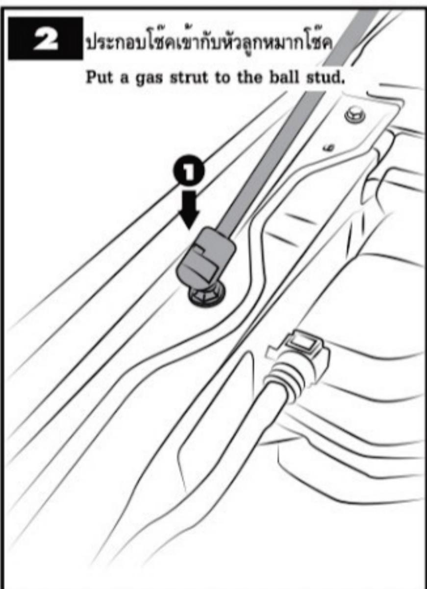
**3** ให้ถอนน็อตที่ฝากระโปรงด้านนอกแล้วใส่ Bracket เข้าไปและทำการขันยึดน็อตเข้าไปเหมือนเดิม แล้วทำการประกอนหัวโซ๊คกับหัวลูกหมาก ในภาพเป็นด้านซ้าย (ให้ทำทั้งสองข้าง)
